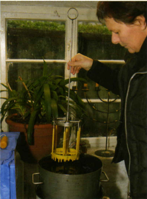
▲ Der Wachstauchbehälter steht in einem handelsüblichen Einkochtopf, während ein zweiter links unter der Wärmehaube das sich klärende Wachs bevorratet.
